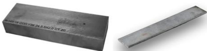
Рисунок 2 - металлические образцы до и после прокатки
