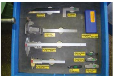
Метод трафаретов (под каждый инструмент сделано свое углубление, подходящее по размеру).
